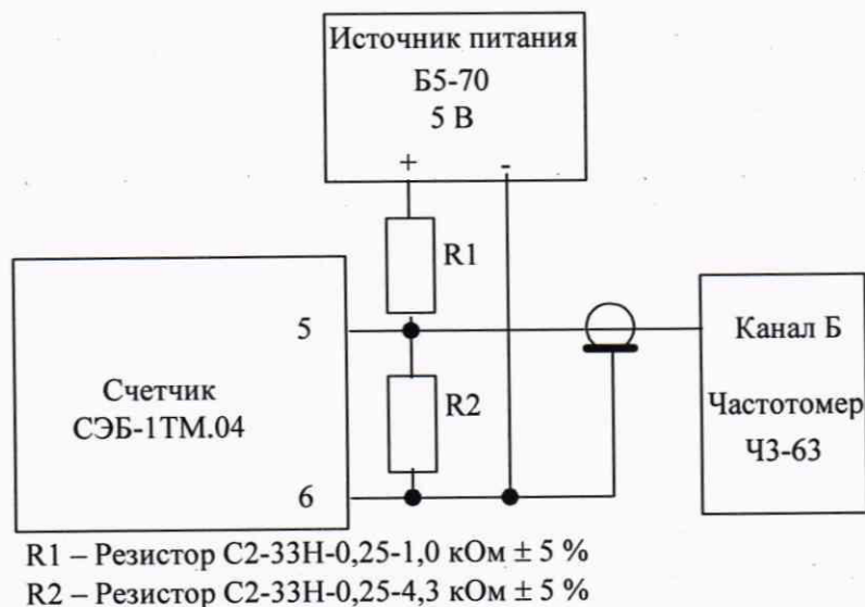
Рисунок 14 – Схема подключения оборудования для проверки точности хода часов
