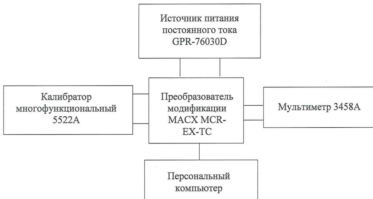
Рисунок 2 – Схема подключений для поверки преобразователя модификации MACX MCR-EX-TC
