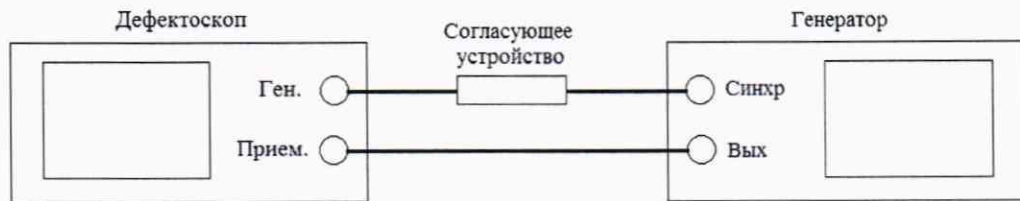
Рисунок 1 - Схема подключения дефектоскопа к генератору
