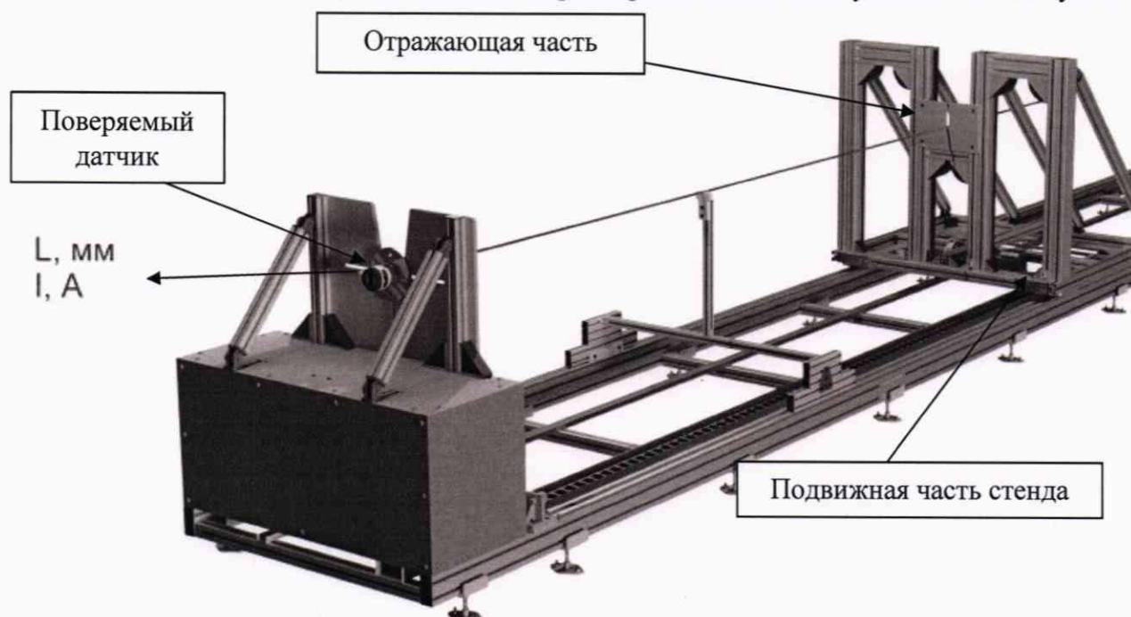
Рисунок 1 - Поверка датчика на поверочной установке с имитацией изменения уровня 1)
