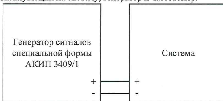
Рисунок 2 – Схема подключения для определения относительной погрешности измерений напряжения постоянного тока
