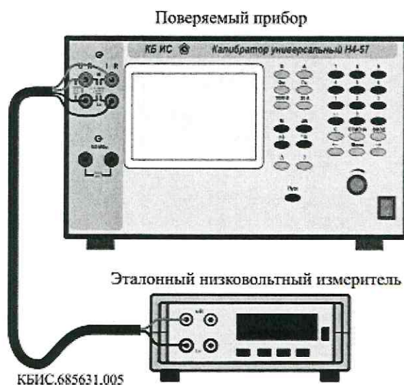
Рисунок 13.3 – Схема измерения для определения погрешности воспроизведения нулевого значения напряжения постоянного тока
