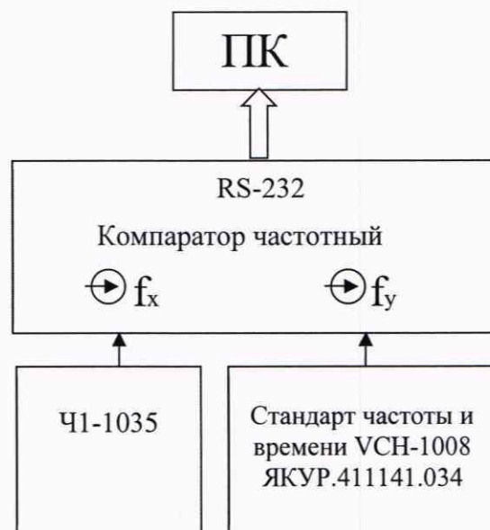
Рисунок 5 - Схема соединения приборов для измерения относительной погрешности по частоте.
