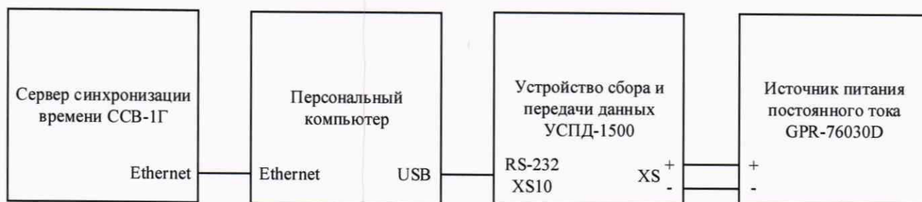
Рисунок 2 – Схема определения подключения приборов при определении основной абсолютной погрешности хода внутренних часов в автономном режиме за сутки
