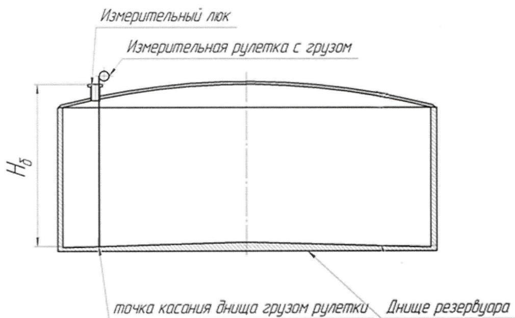
Рисунок А.1 – Схема измерения базовой высоты резервуара и эталонного расстояния уровнемера
