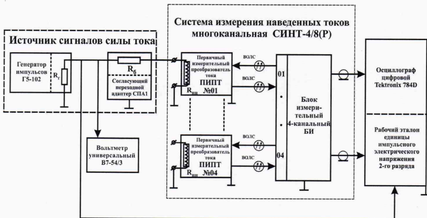
Рисунок 3 – Схема соединений при определении метрологических характеристик системы СИНТ-4/8(Р)
