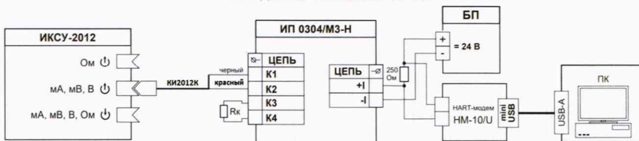
Рисунок А.10 – Схема электрическая подключений при поверке ИП (с внешним компенсатором холодного спада) с входными сигналами от ТП
