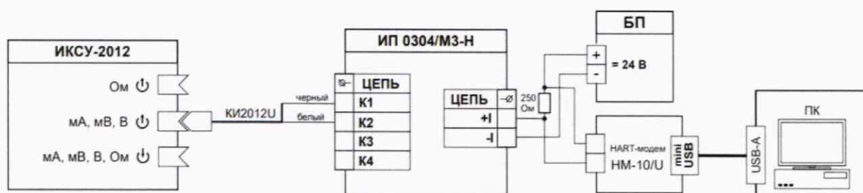
Рисунок А.8 – Схема электрическая подключений при поверке ИП (с индексом заказа С с фиксированным компенсатором холодного спада) с входными сигналами от ТП
