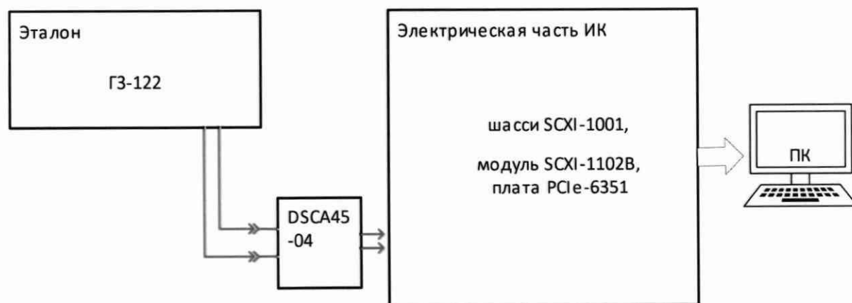
Рисунок 10 – Схема поверки ИК частоты периодического сигнала, соответствующего частоте вращения роторов
