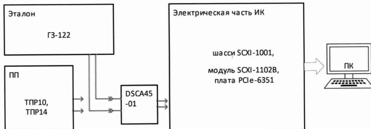
Рисунок 9 – Схема поверки ИК объемного расхода (прокачки) масла (гидросмеси)
