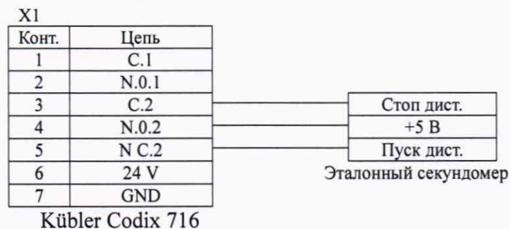
Рисунок А.2. Схема определения абсолютной погрешности измерений интервалов времени в рабочем диапазоне измерений
