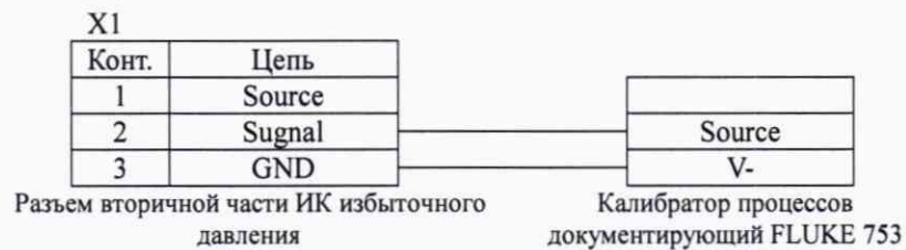
Рисунок А.1. Схема определения метрологических характеристик вторичной части ИК избыточного давления
