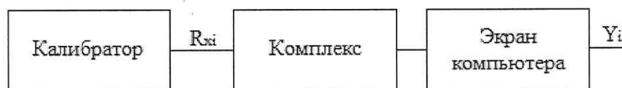
Рисунок 3 - Схема подключений при определении погрешностей ИК
