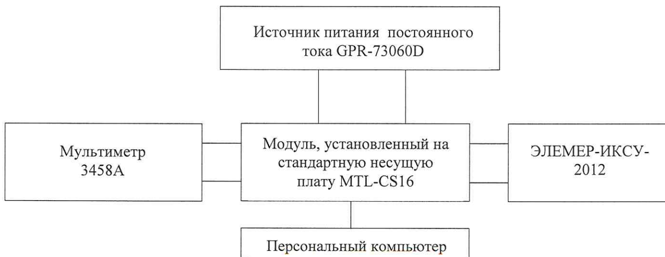
Рисунок 2— Схема подключений для поверки модуля в режиме аналогового вывода «АО»
