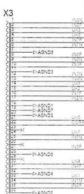
Рисунок Ж.9 - Распайка разъема мезонина МН8ИП
