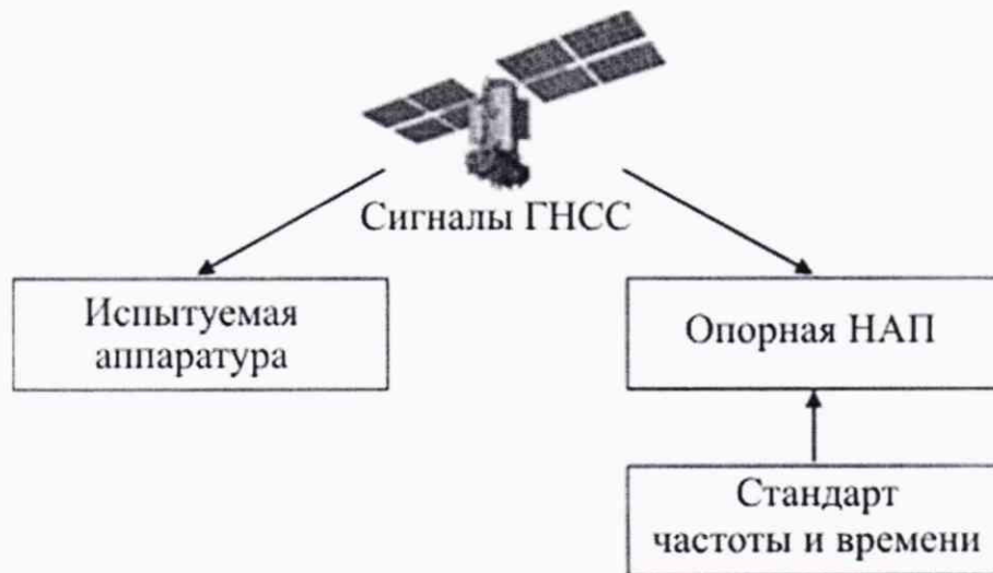
Рисунок 1 — Структурная схема проведения измерений
