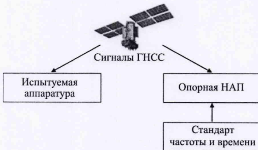
Рисунок 1 — Структурная схема проведения измерений
