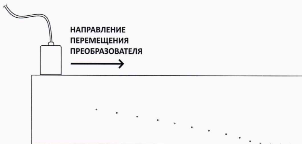
Рисунок 4 – Положение преобразователя на поверхности меры МД 2-0-1
