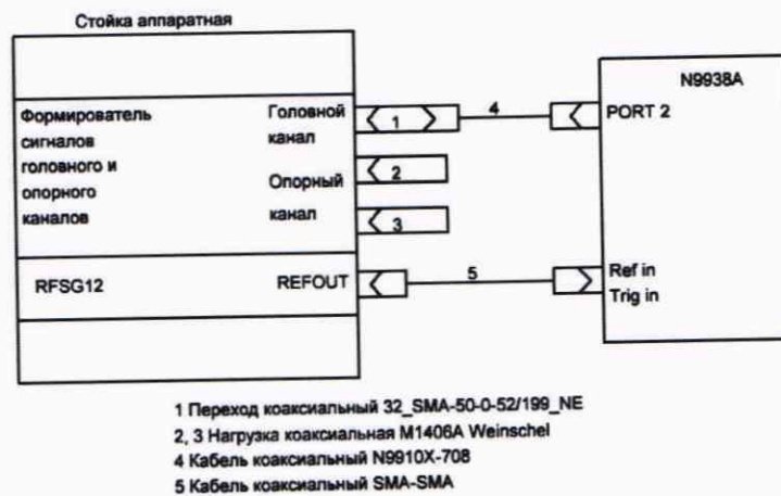
Рисунок 21 – Схема измерений установки уровня выходной мощности головного канала
