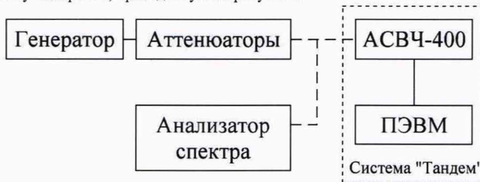
Рисунок 6 – Схема измерений динамического диапазона измерений уровня синусоидального сигнала, максимального измеряемого уровня мощности синусоидального сигнала, абсолютной погрешности измерения уровня мощности синусоидального сигнала
