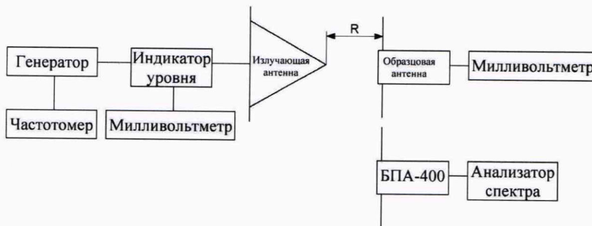
Рисунок 7 – Схема измерений коэффициента калибровки антенны
