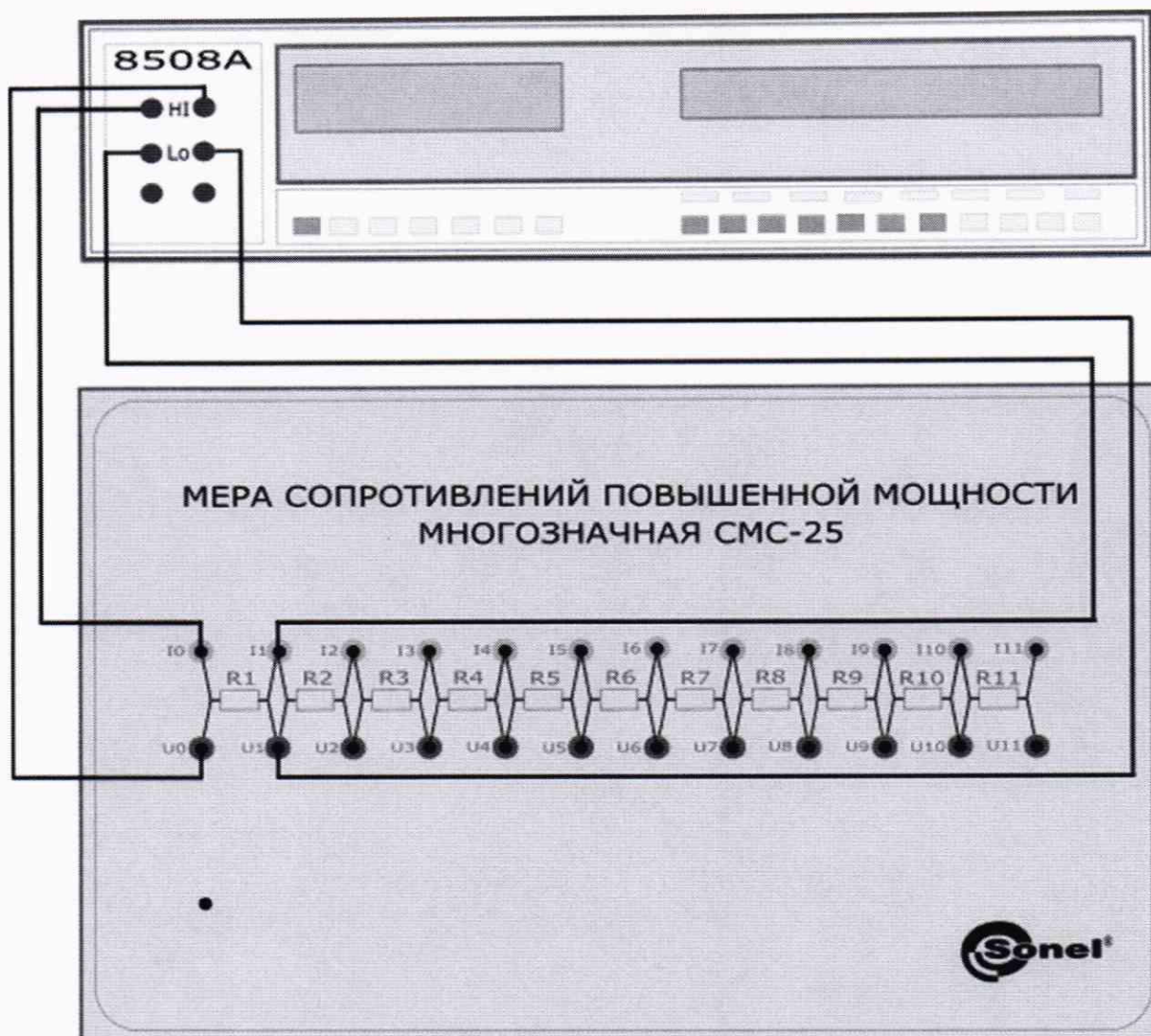
Рисунок 1 - Структурная схема определения абсолютной погрешности воспроизведения электрического сопротивления,
