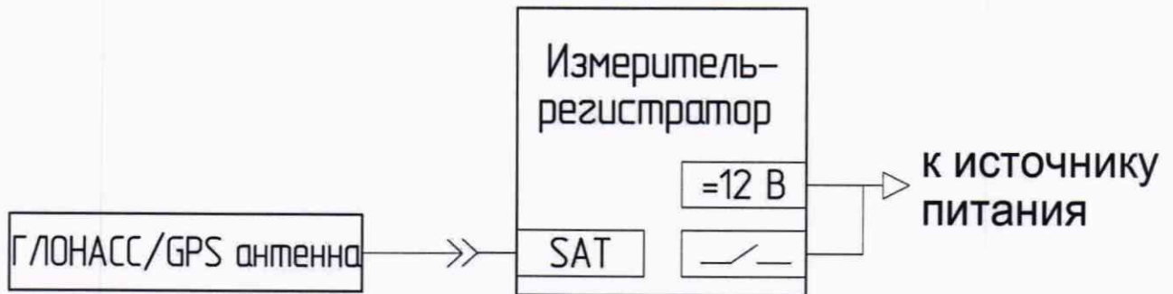
Рисунок 1 — Схема подключения регистратора для проверки работоспособности
