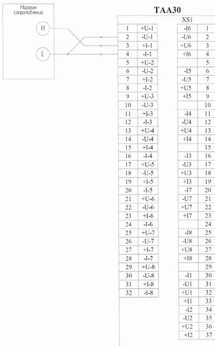
Рисунок А.7 – Пример подключения имитатора (магазин сопротивлений) к модулю AI102 через полевой адаптер TAA30 для задания сигналов имитации термопреобразователей ТСМ и ТСП, подключенных по трехпроводной схеме подключения
