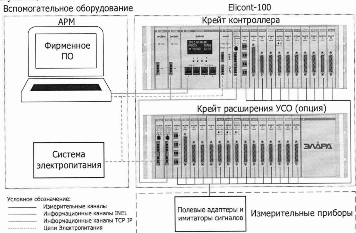
Рисунок 1 – Структурная схема стенда для поверки ИК
