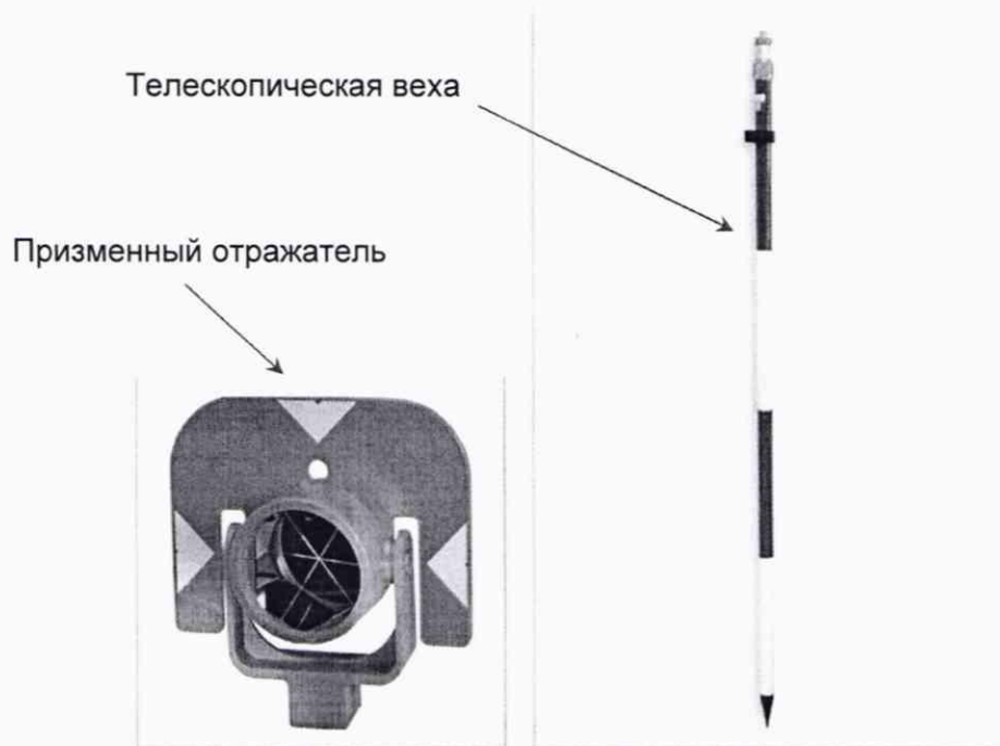
Рисунок А.1 – Веха телескопическая с призмным отражателем
