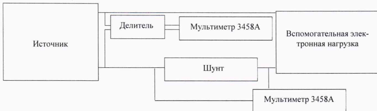
Рисунок 5 - Структурная схема определения нестабильности выходного напряжения постоянного, вызванной изменением силы тока в нагрузке, и нестабильности силы выходного тока, вызванной изменением напряжения на нагрузке (св. 1000 В)
