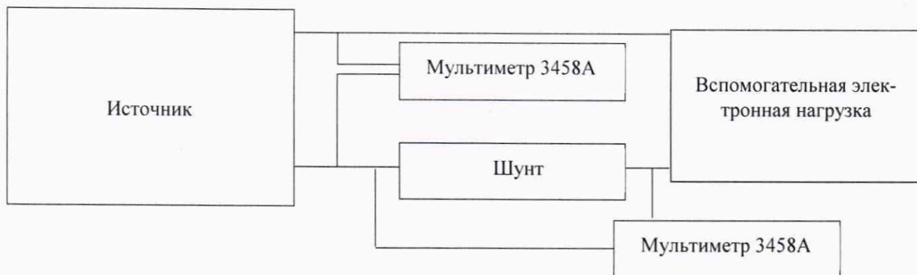
Рисунок 4 - Структурная схема определения нестабильности выходного напряжения постоянного тока, вызванной изменением силы тока в нагрузке, и нестабильности силы выходного тока, вызванной изменением напряжения на нагрузке (от 0 до 1000 В включ.)
