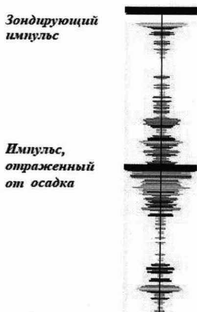
Рисунок Г.1- Пример эхограммы сигнала в емкости на месте эксплуатации (отрагатель- поверхность осадка)
