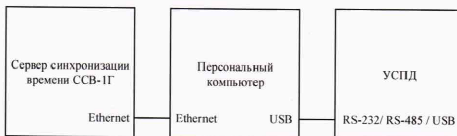
Рисунок 1 – Схема подключения приборов при определении основной абсолютной погрешности хода внутренних часов в автономном режиме за сутки
