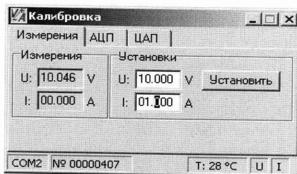
Рисунок 11.3 – Окно калибровки (вкладка «Измерения»)
