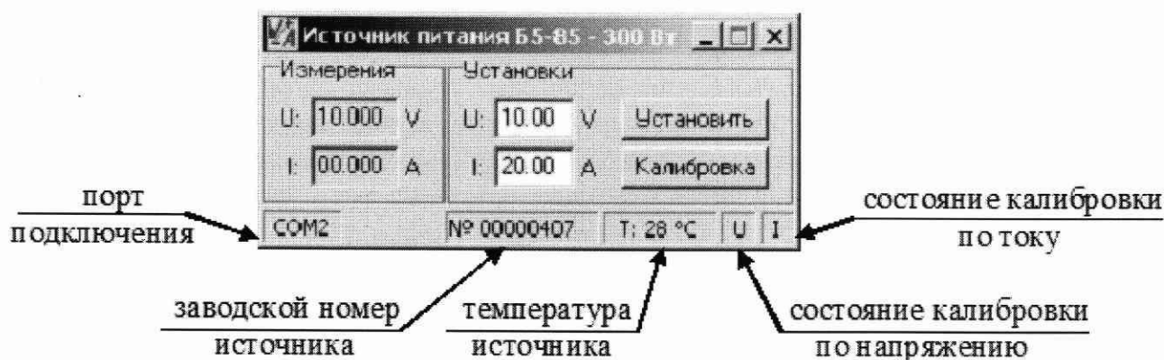
Рисунок 9.5 – Окно программы управления работой источника
