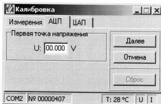
Рисунок 11.2 – Окно калибровки (вкладка «АЦП» с установленными значениями для калибровки АЦП напряжения)
