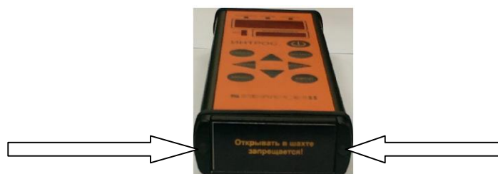
Рисунок 3 - Схема пломбировки от несанкционированного доступа
