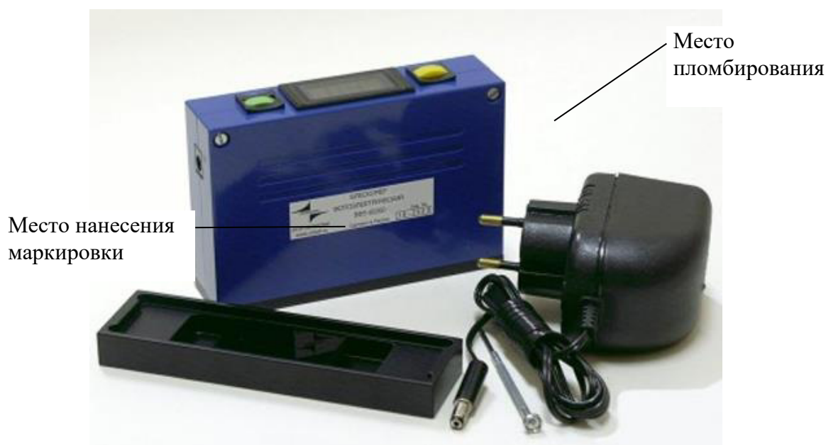
Рисунок 1 – Общий вид блескомеров фотоэлектрических БФ5 с указанием мест нанесения маркировки и пломбирования
