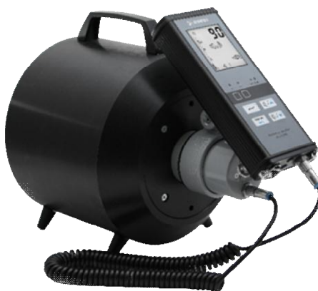
Рисунок 2 – Прибор в составе с БДКН-03 и БОИ2
