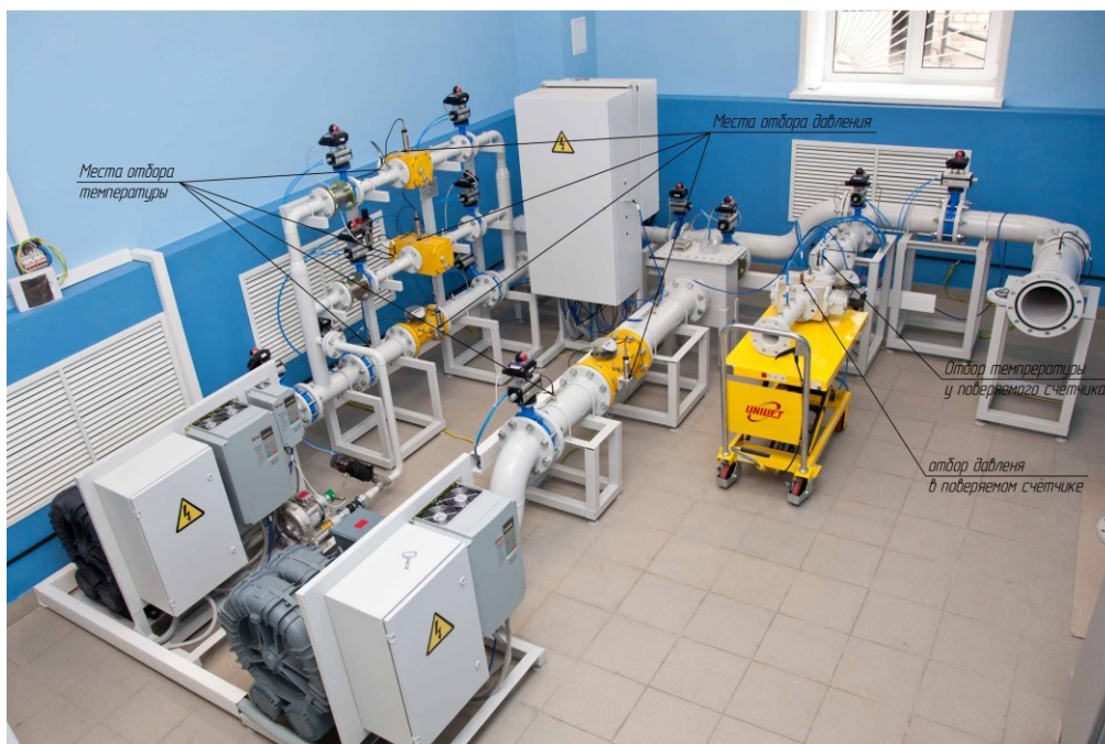
Рисунок 1 – Общий вид установки поверочной УПГ с указанием мест отбора давления и температуры
