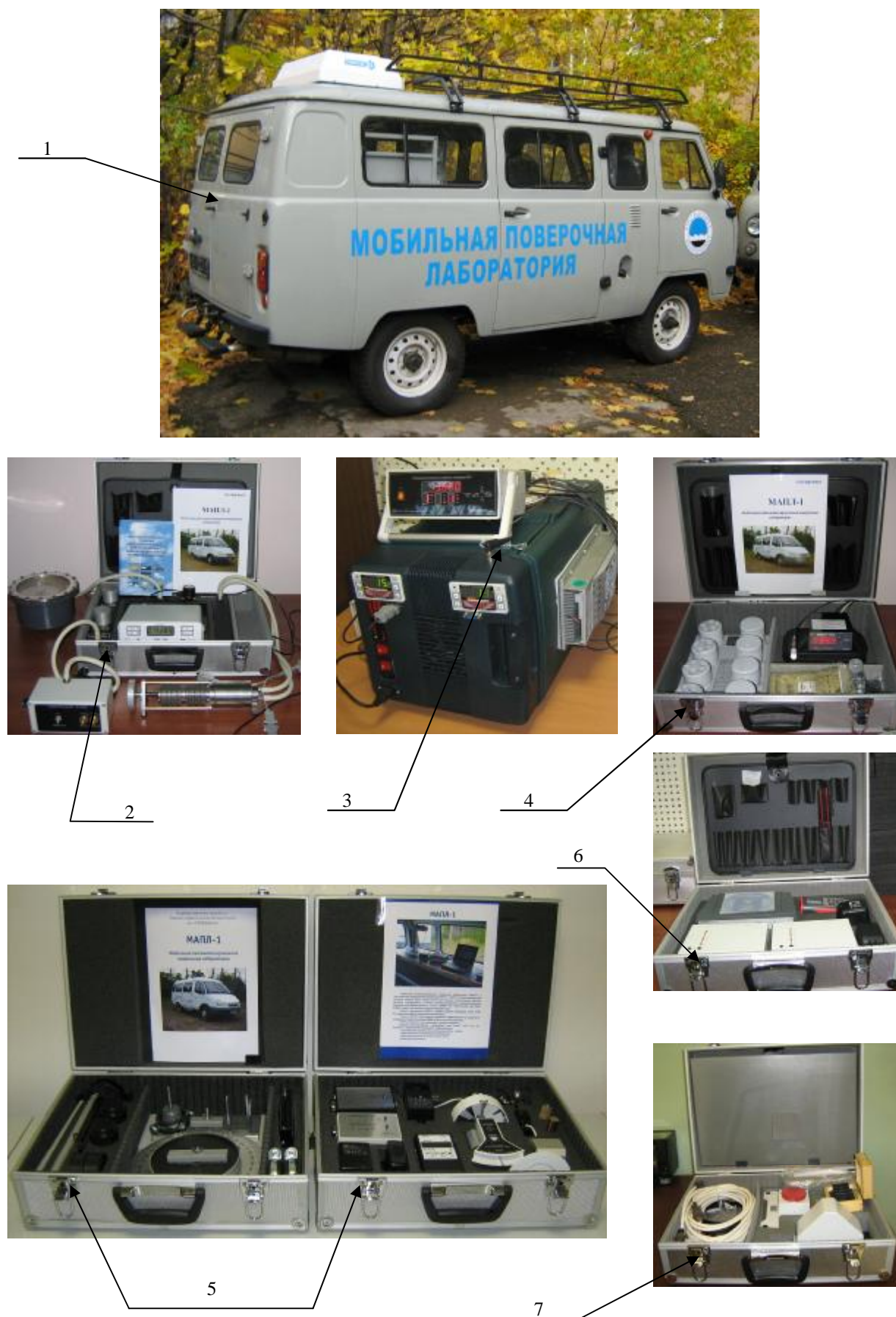
Рисунок 1 - Фотография общего вида МАПЛ-1 и места пломбирования составных частей КПП-1, КПП-2, КПП-3, КПП-4, КПП-5 и КПП-6 (отмечены выносками 2 - 7).
