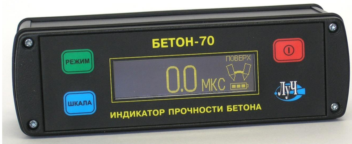
Рисунок 1 - Общий вид приборов ультразвуковых «Бетон-70»
