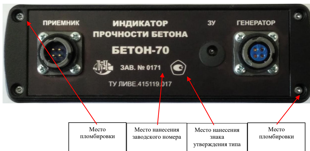
Рисунок 2 – Места нанесения пломбировки, место нанесения знака утверждения типа и заводского номера.
