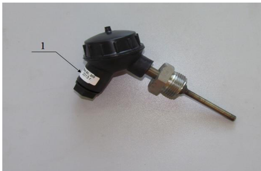
Рисунок 1 – Внешний вид термометра платинового технического ТПТ-20. (1 – место нанесения маркировки)
