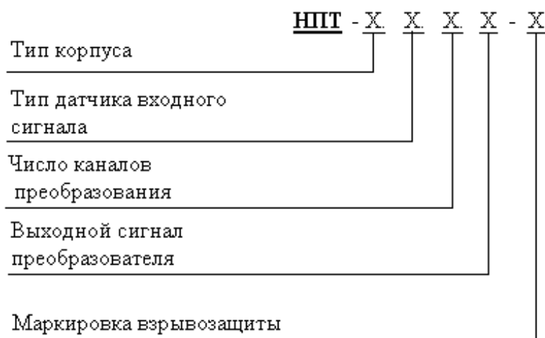
Рисунок 1 - Структура условного обозначения преобразователей
