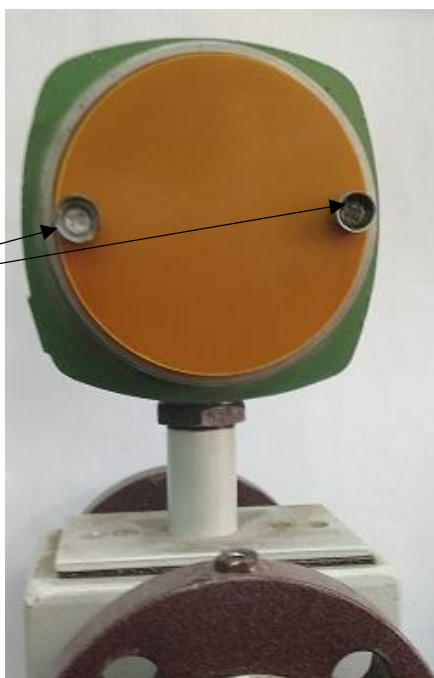
Рисунок 2 - Схема пломбировки от несанкционированного доступа преобразователей расхода ИТЭМ
