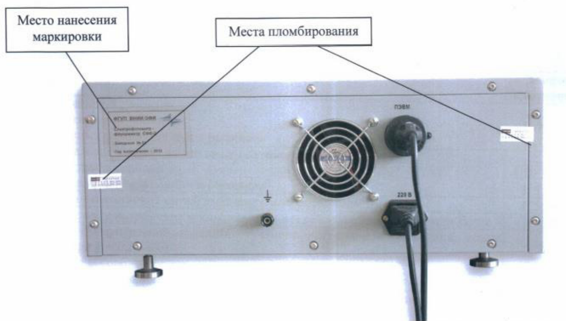
Рисунок 2 - Общий вид спектрофотометров-флуориметров СФФ-2 «ФЛУОРАН» (вид сзади) с обозначением мест нанесения маркировки и пломбирования
