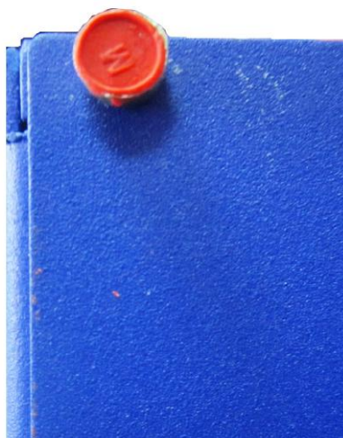
Рисунок 2 – Место пломбировки регистратора от несанкционированного доступа
