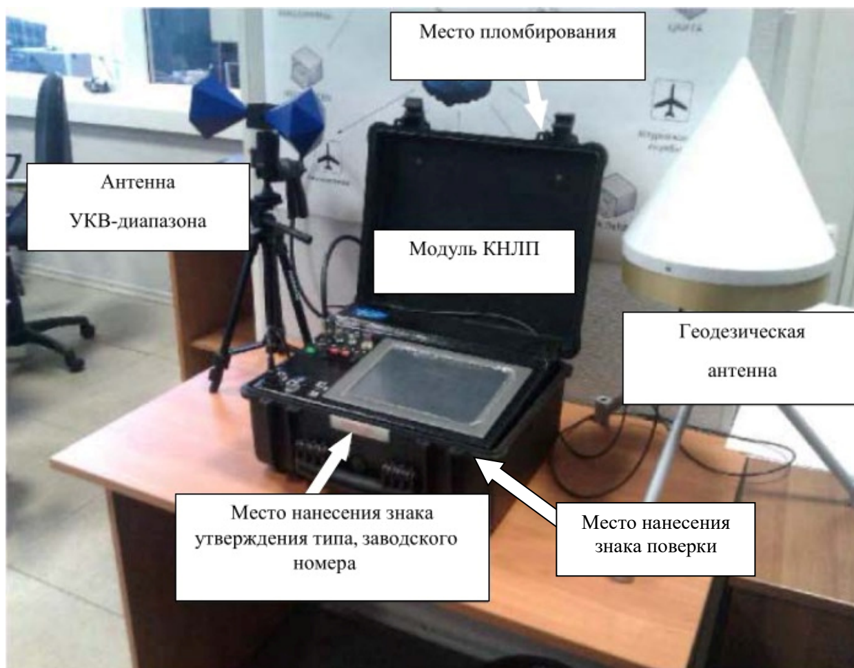
Рисунок 1 - Общий вид КНЛП, место пломбировки от несанкционированного доступа, место нанесения знака утверждения типа, место нанесения заводского номера и знака поверки
