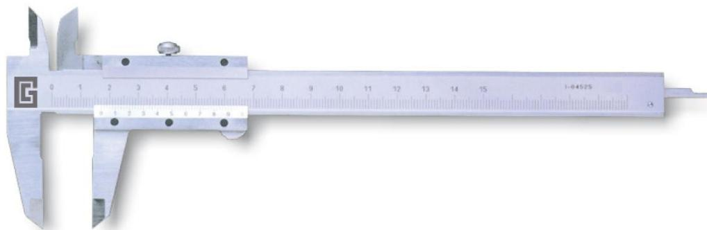
Рисунок 1 - Общий вид штангенциркулей типа ШЦ-1.
