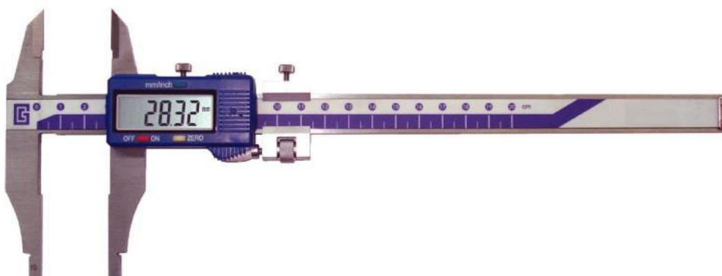
Рисунок 5 - Общий вид штангенциркулей типа ШЦЦ-П.
