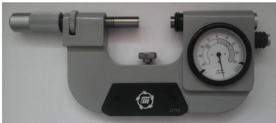
Рисунок 1 - Общий вид скобы с отсчетным устройством типа СР.
