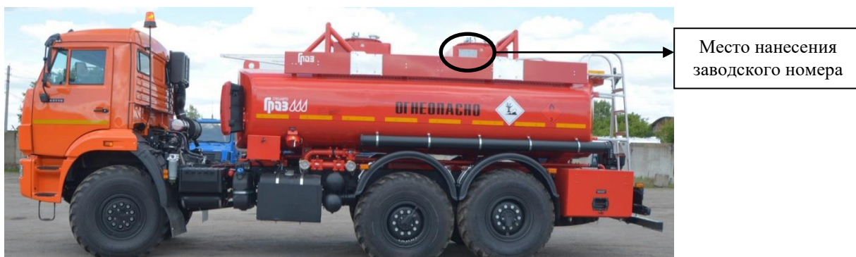
Рисунок 1 – Общий вид автоцистерны ГРАЗ-АЦ-11,0 и место нанесения заводского номера
