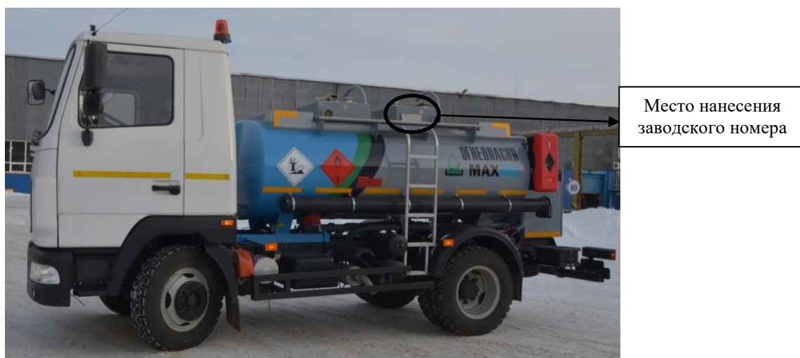
Рисунок 2 – Общий вид автотопливозаправщика ГРАЗ-АТЗ-5,5 и место нанесения заводского номера
