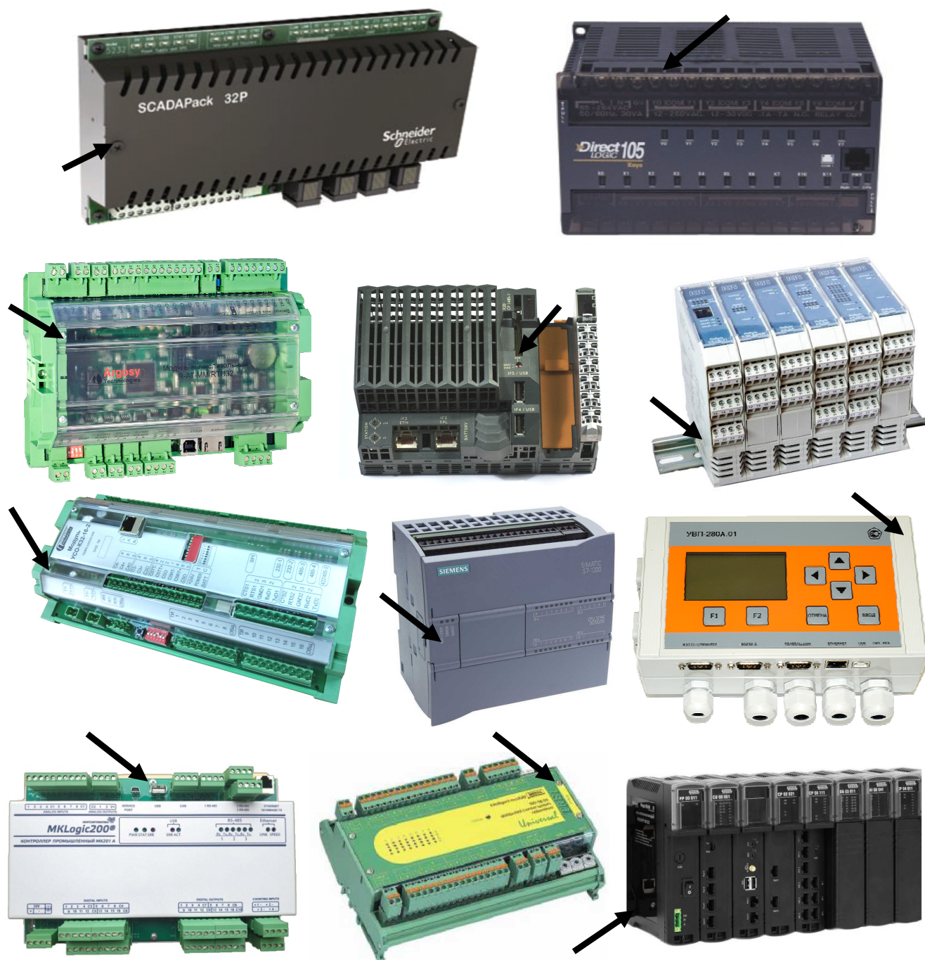
Рисунок 3 - Схема пломбировки от несанкционированного доступа, обозначение нанесения пломб или наклеек
