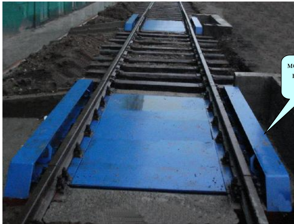
Рисунок 7. Общий вид весов вагонных электронных ЭСВ-В
