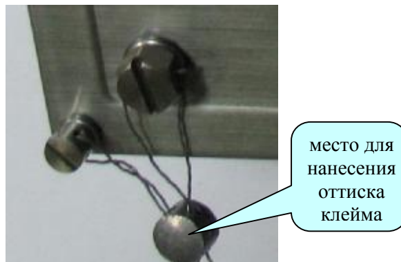
Рисунок 1. Схема защиты от несанкционированного доступа в настройки индикаторов CI-2001AS, CI-2001A и обозначение места для нанесения отиска клейма.
