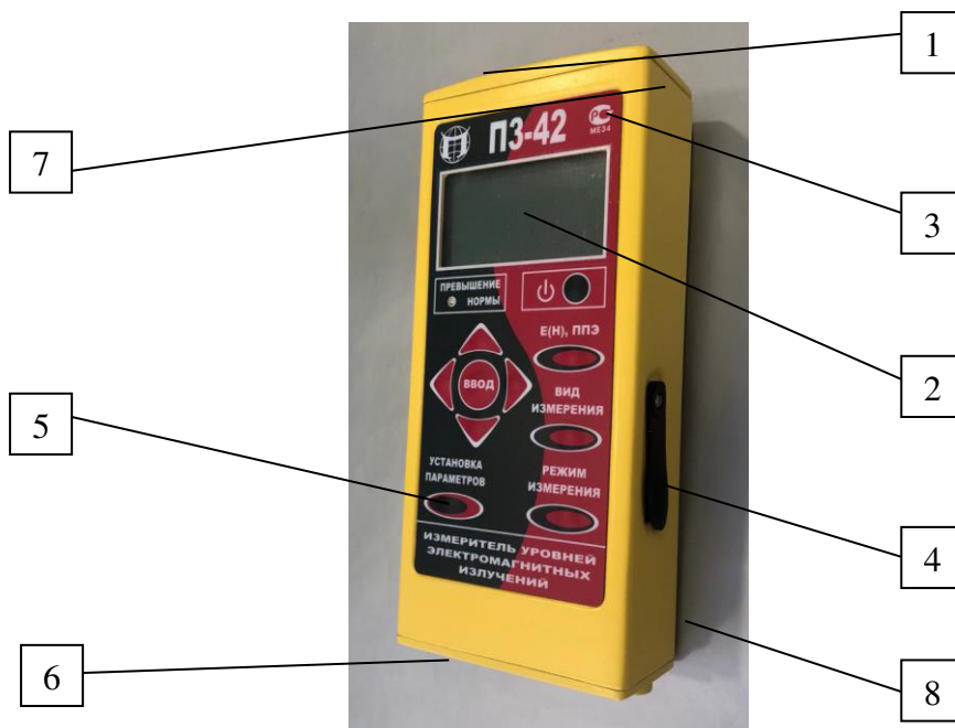
1 – цанговый разъем, 2 – цветной ЖК-дисплей, 3 – место нанесения знака утверждения типа, 4 – разъем подключения оптоволоконный кабеля, 5 – органы управления, 6 – крышка блока питания, 7 – наклейка от несанкционированного доступа, 8 – место нанесения заводского номера
