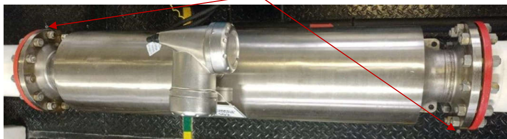
Рисунок 2 – Место нанесения знака поверки и места установки пломб
