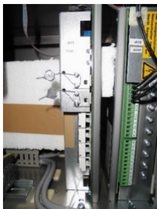
Рисунок 5 - Место пломбирования электронного счетного устройства ER5
