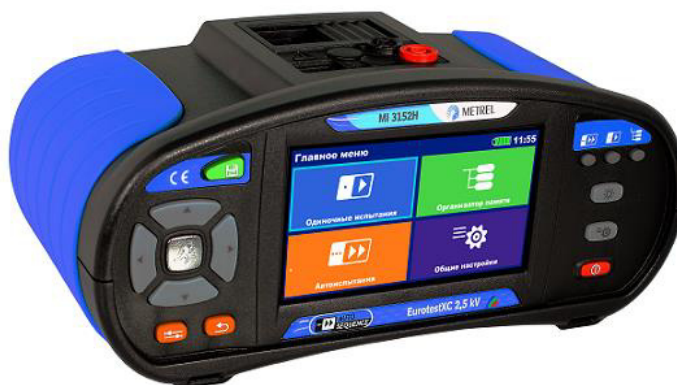
Рисунок 1 - Общий вид измерителей MI 3152 (MI 3152H)
